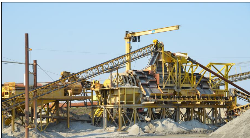
FIGURA 34 – FOTO IMPIANTO DI SELEZIONE E LAVAGGIO INERTI DI CAVA
